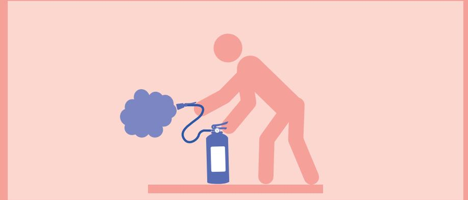
**3.** Presionar la palanca de la cabeza del extintor y en caso de que exista apretar la palanca de la boquilla realizando una pequeña descarga de comprobación.
