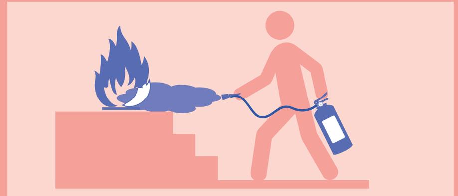
**4.** Dirigir el chorro a la base de las llamas con movimiento de barrido. En caso de incendio de líquidos proyectar superficialmente el agente extintor efectuando un barrido evitando que la propia presión de impulsión provoque derrame del líquido incendiado. Aproximarse lentamente al fuego hasta un máximo aproximado de un metro.
