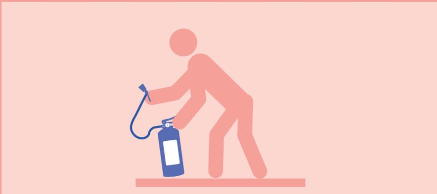
**2.** Asir la boquilla de la manguera del extintor y comprobar, en caso de que exista, que la válvula o disco de seguridad (V) está en posición sin riesgo para el usuario. Sacar el pasador de seguridad tirando de su anilla.
